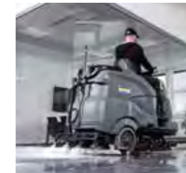
Scheuersaugmaschinen für große Flächen ab rund 500 m 2 .
